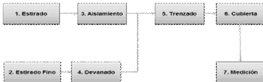
Diagrama 1. Proceso de producción de cable coaxial
