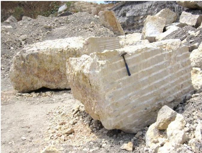
Bloques de caliza "Mármol Dorado", cortados con barrenación corta hidráulica. Localidad Banco Flores, Mpio. San Juan Ixcaquixtla, Pue.
