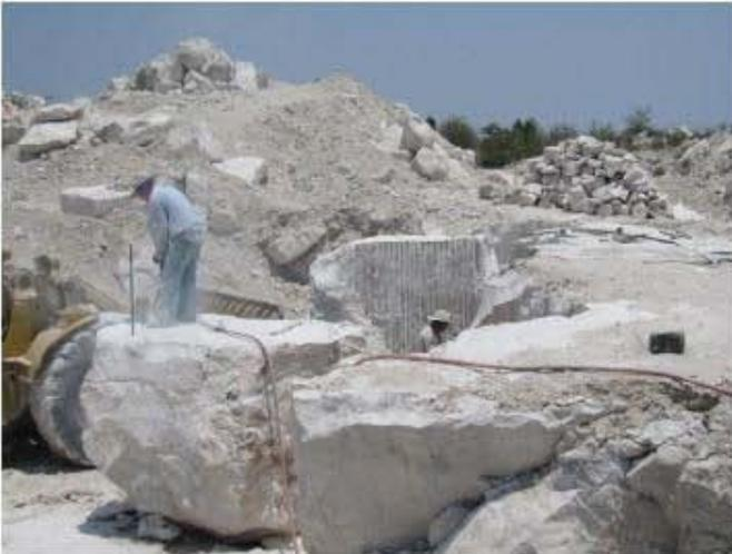
Bloques de travertino desprendidos con polvo expansivo y cortados con
