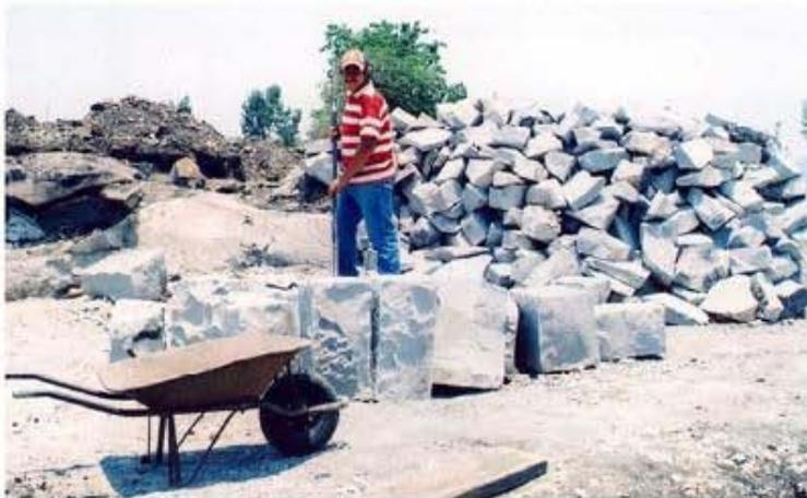
Detalle de la extracción de bloques de cantera gris. Se labran únicamente Usando cuña y marro.
