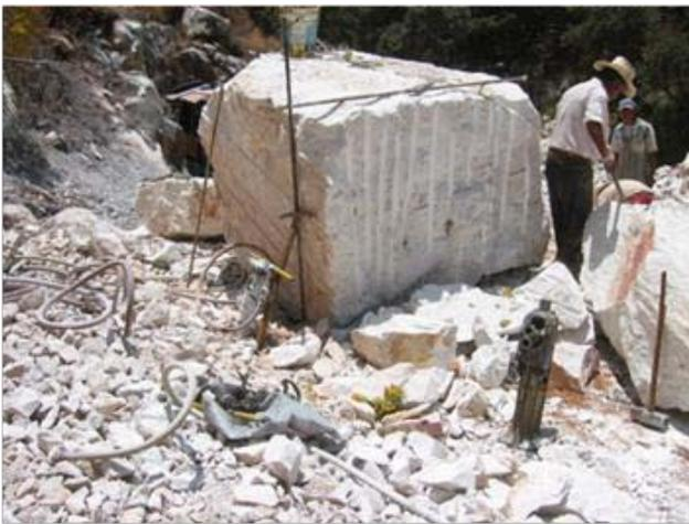
Detalle de la extracción en la cantera Chavarrías, Mpio.
