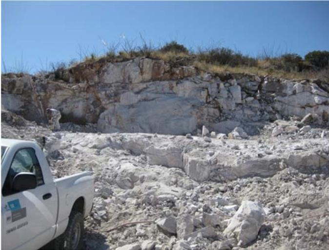
Aspecto de un tajo de explotación de caliza recristalizada, con una pureza del 97-99% de  $\text{CaCO}_3$ , en la localidad El Árabe, Chihuahua, Chih.
