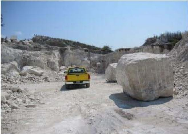
Bloques de travertino de 3 X 2 X 2.5 m para laminarse en la planta de la compañía Extracciones de Mármol,
