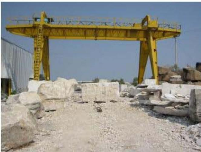
Bloques de travertino de 3 X 2 X 2.5 m para laminarse en la planta de la compañía Extracciones de Mármol,
