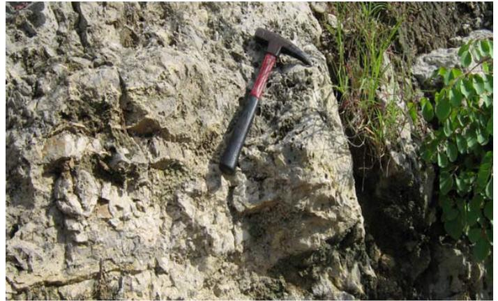
El Predio "Los Asmoles" en Colima, contiene una cantidad de reservas calizas estimadas en 353'625,000 Toneladas minables o extraíbles mediante un Tajo a Cielo Abierto con 75° de talud general en bancos descendentes por 305 metros verticales (desde el nivel o cota 705 al 400 sobre el nivel del mar) con una calidad o Ley Media de 95.10 % en CaCO<sub>3</sub> o su equivalente en Óxido de Carbonato (CaO) de 53.42%.
