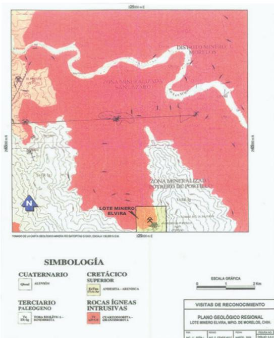
Las estructuras mineralizadas son de origen hidrotermal-epitermal en forma de cuerpo tabular con minerales: plomo, zinc y plata relleno de fisuras, originadas por fallamiento previo de la andesita, que es la roca encajonante y que fue intrusión por una roca granodiorítica, la cual aportó los fluidos mineralizantes relleno de dichos espacios constituyendo al yacimiento.
