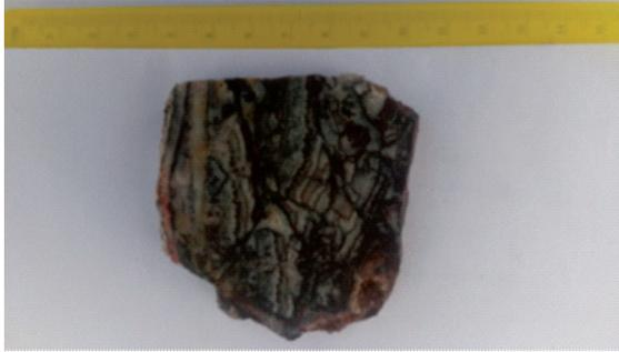
La baja sulfuración es aparente, con enriquecimiento en zonas Au (+ 0.2 ppm) hacia el norte en Mo y W. Enriquecimiento hacia el sur en Ag, Pb, Zn, Cd, Bi, Hg, Sb, As y Mn.
